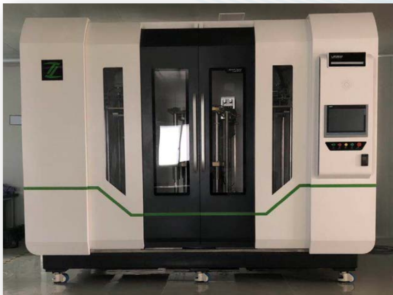
联合开发国内首套自动化电堆装配系统
