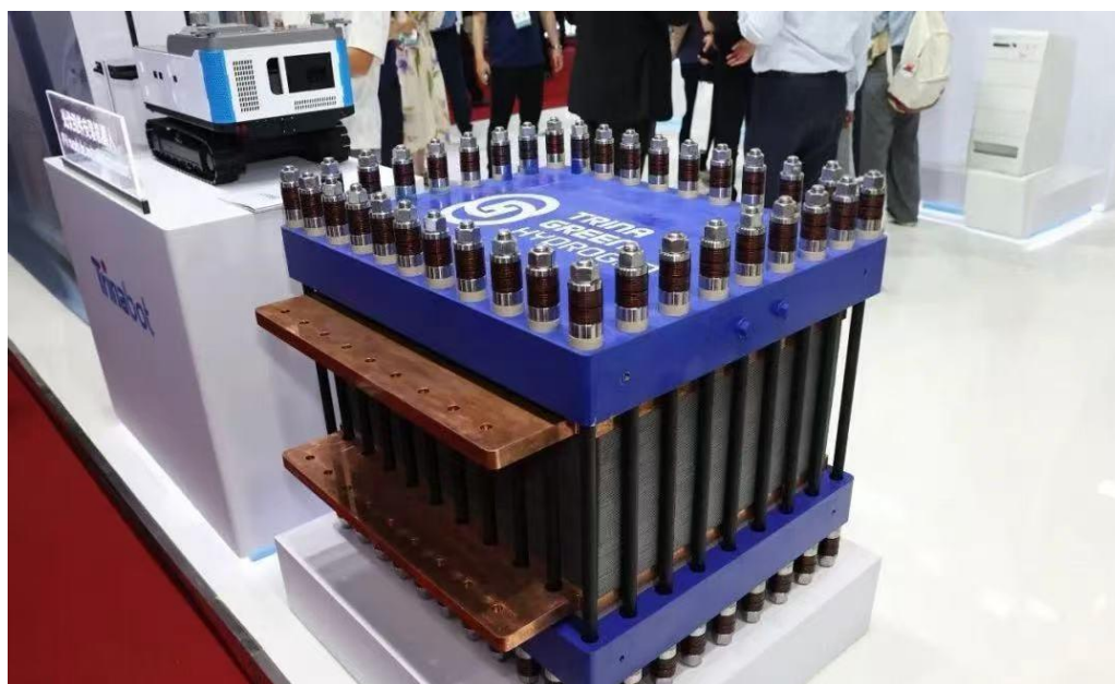
图 12 天合元氢 PEM 电解槽
